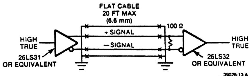
FIGURE 2-9. DATA TRANSFER LINE DRIVER/RECEIVER COMBINATION
