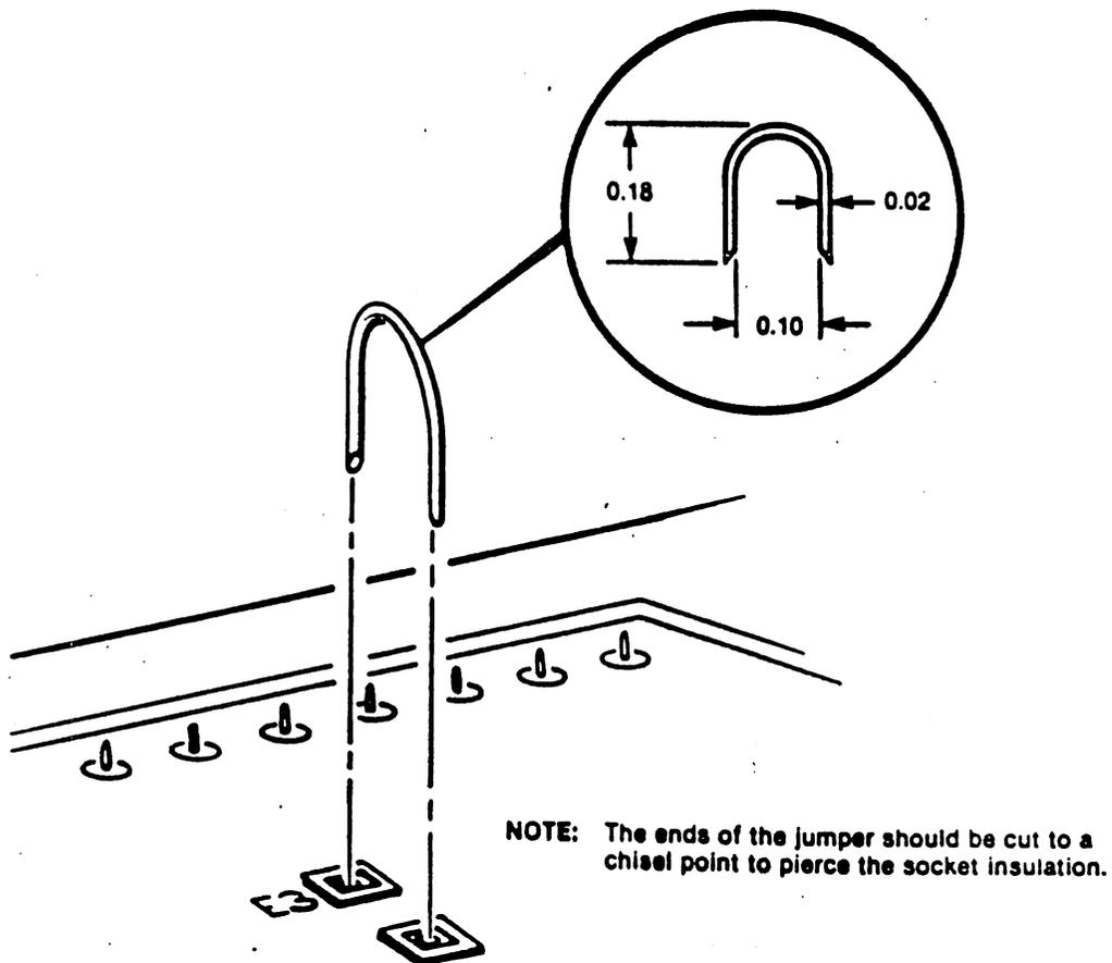
FIGURE 7-3. JUMPER INSTALLATION AND FABRICATION
