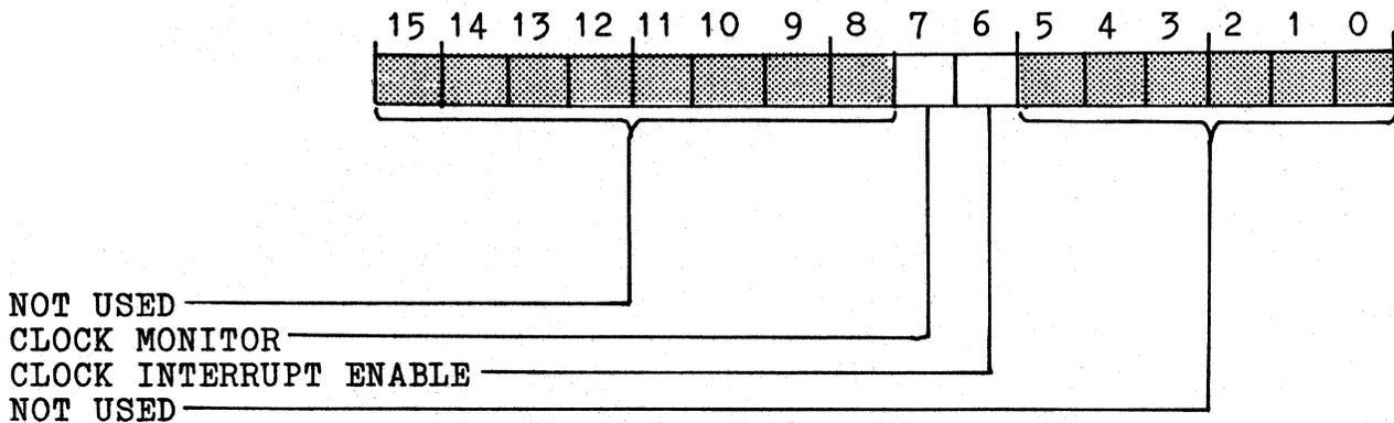
FIGURE 3-5; CSR (177546) CLOCK REGISTER FORMAT
