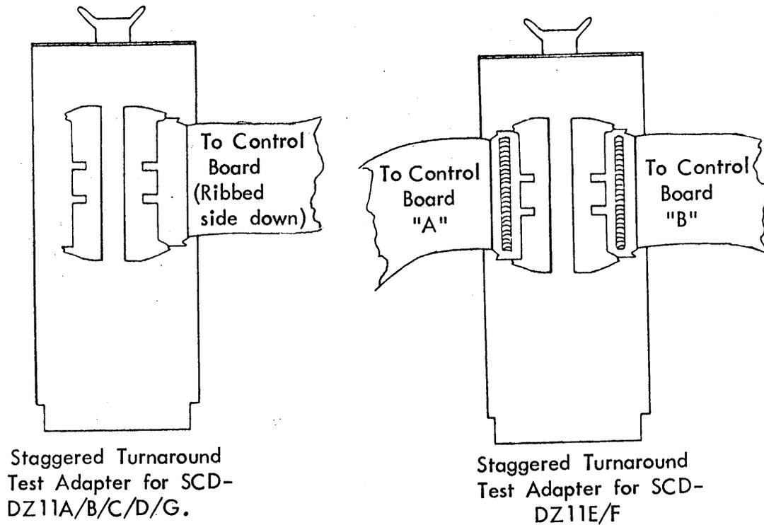
FIGURE 1-7: STAGGERED TURNAROUND TEST ADAPTER
