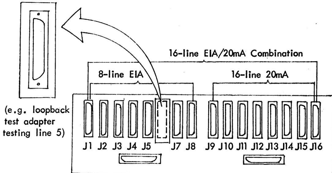
FIGURE 1-6: LOOP BACK TEST ADAPTER FOR EIA CONFIGURATIONS
