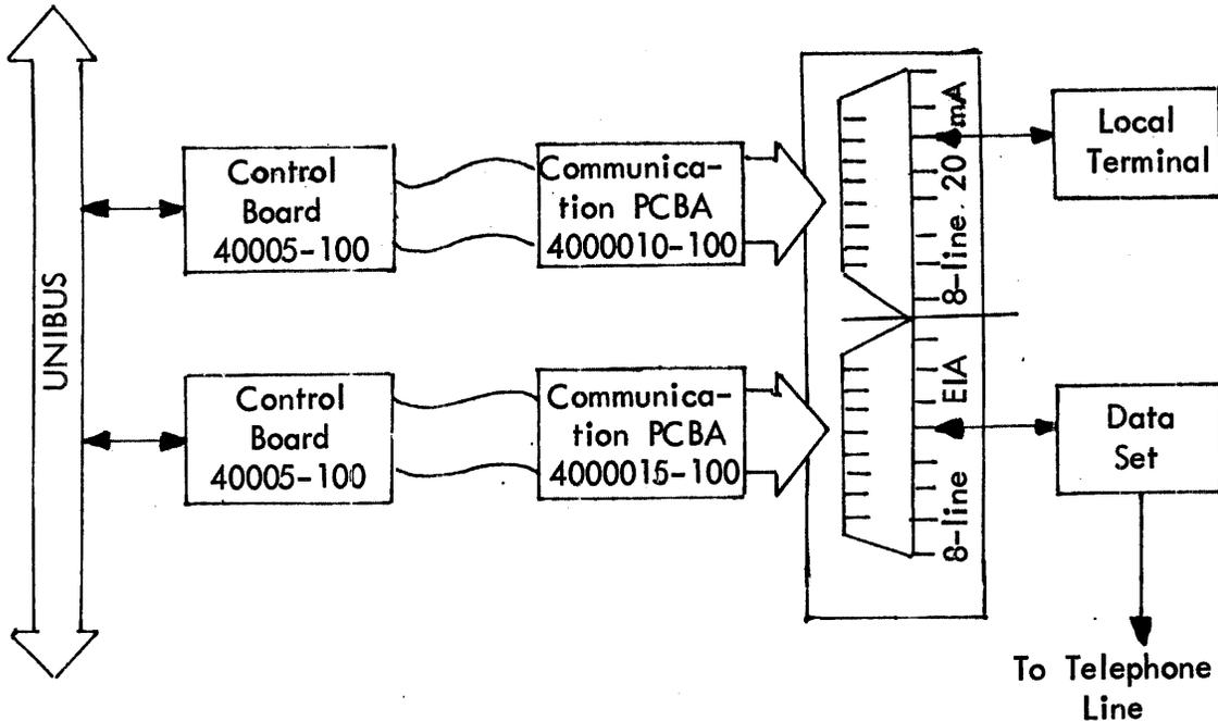
FIGURE 1-4: REQUIRED HARDWARE FOR EIA/20mA COMBINATION CONFIGURATION
