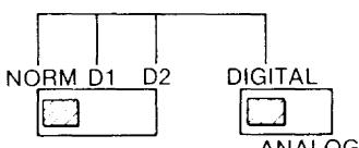
D1-DIGITAL: réservée aux micro-ordinateurs à sortie RGB TTL et signal I, tels que PC, AT et XT IBM utilisant une carte graphique standard.
