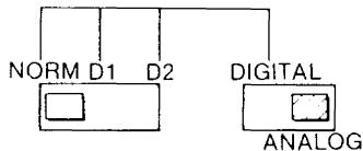
NORM-DIGITAL: réservée aux micro-ordinateurs à sortie RGB TTL, tels que le 3270 IBM.
