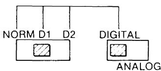
D2-DIGITAL: réservée aux PC, AT et XT IBM à carte graphique TTL (réglage automatique pour les cartes EGA, CGA et MDA).
