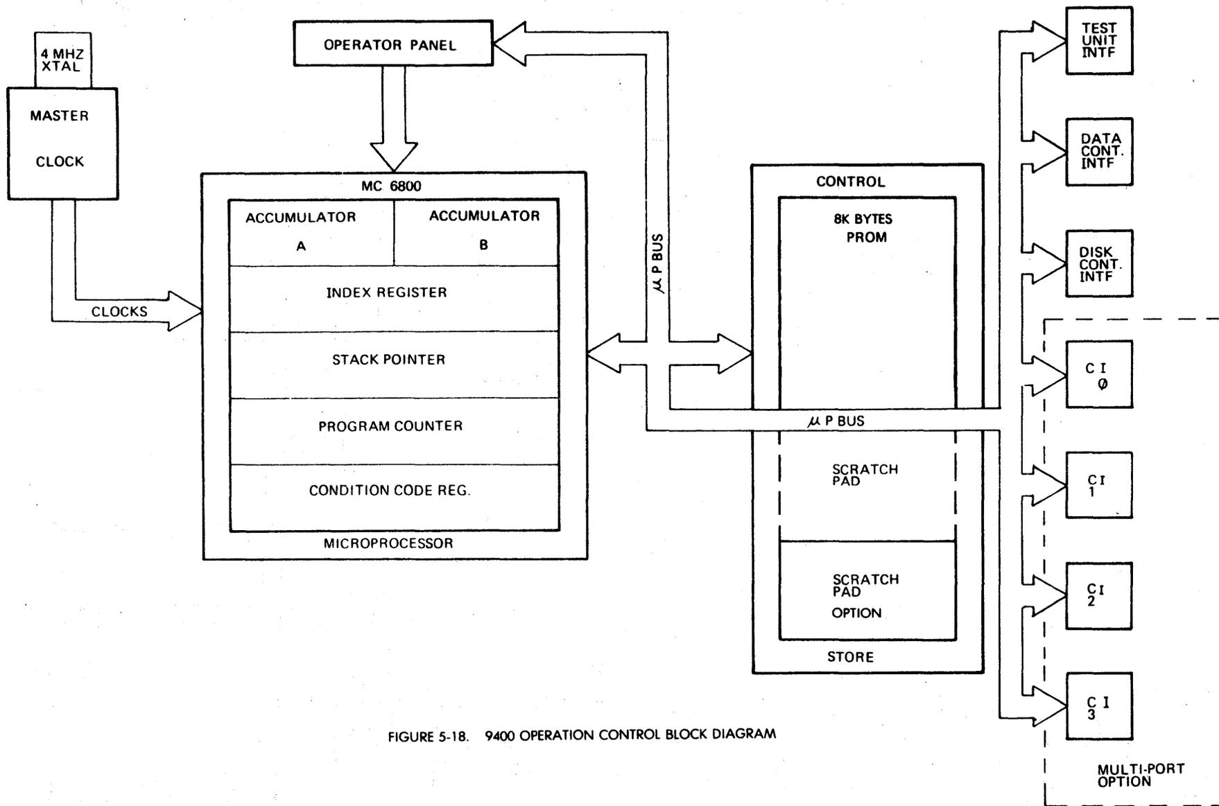
FIGURE 5-18. 9400 OPERATION CONTROL BLOCK DIAGRAM
