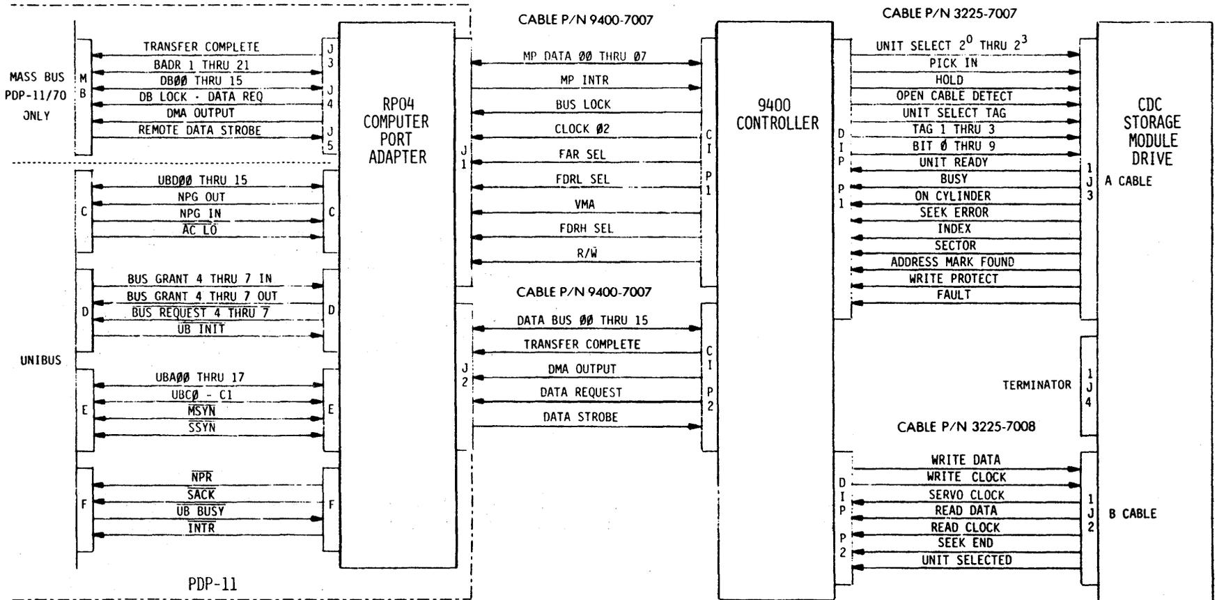
FIGURE 5-2. 9400 DISK SYSTEM SIGNAL INTERCONNECT FLOW DIAGRAM
