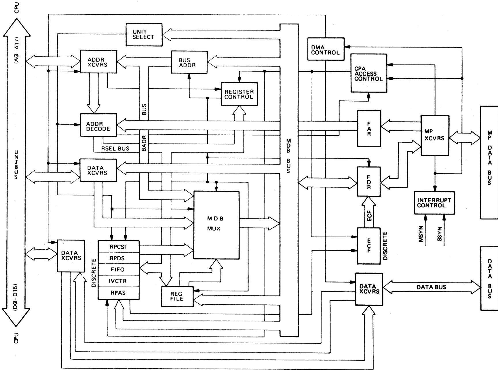
FIGURE 5-4. RP04 CPA BLOCK DIAGRAM
