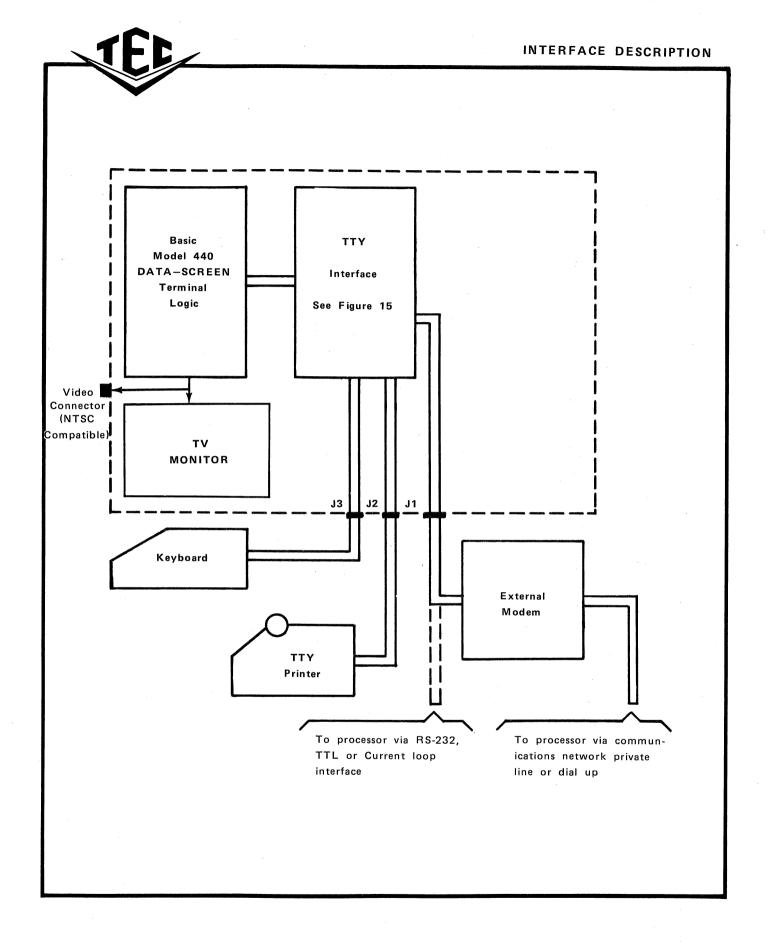
FIGURE 16 SYSTEM DIAGRAM - MODEL 440 DATA-SCREEN TERMINAL
