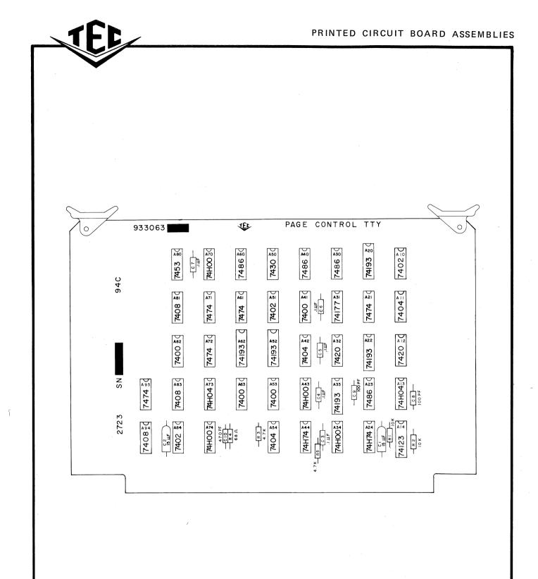
FIGURE 23 MODEL 440 PAGE CONTROL PRINTED CIRCUIT BOARD
