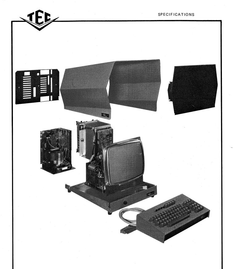
FIGURE 28 EXPLODED VIEW - TYPICAL DATA-SCREEN TERMINAL ASSEMBLY
