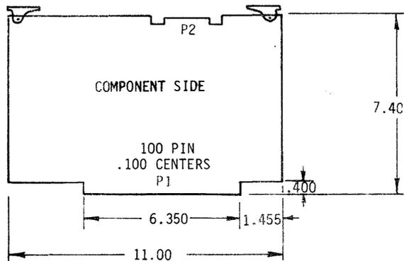
FIGURE 8-10 1702A PROM PROGRAMMER ENVIRONMENTAL, POWER AND PHYSICAL REQUIREMENTS
