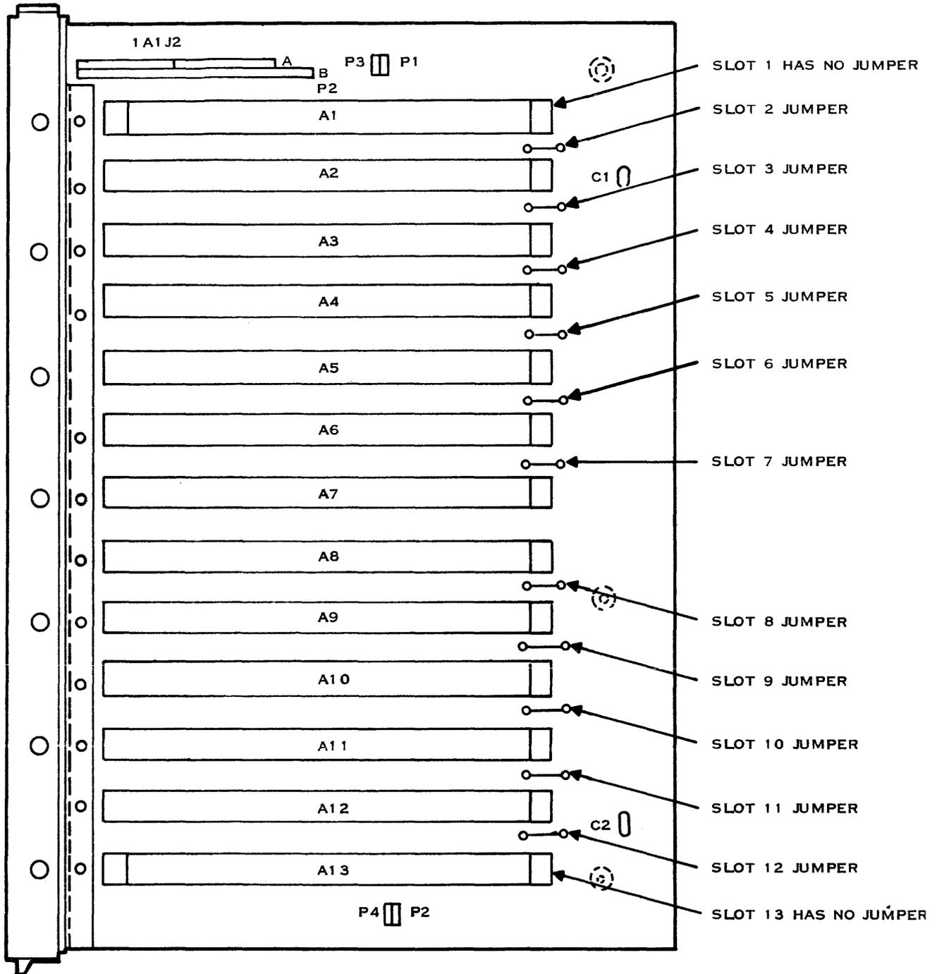
NOTE: JUMPER MAY BE EITHER A REMOVABLE JUMPER PLUG OR A WIRE WHICH MUST BE CUT.
