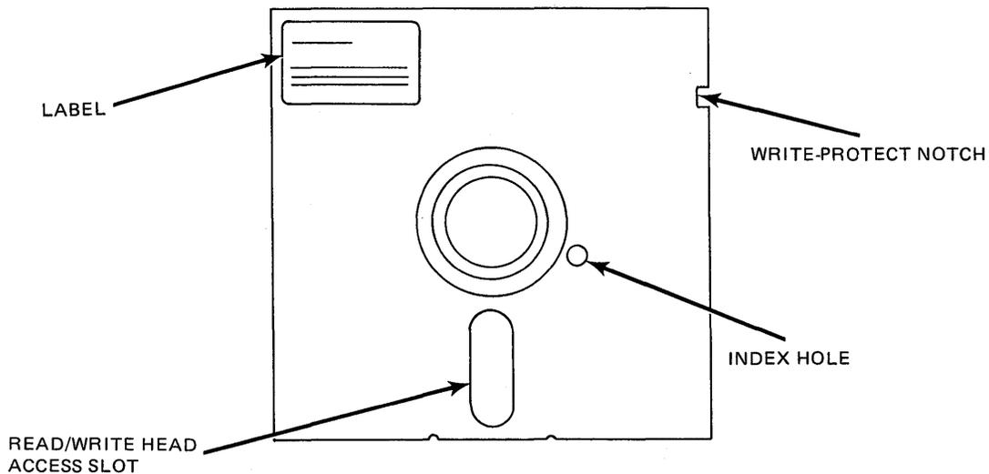
Figure 3-1. 5¼-Inch Diskette Used in the Diskette Subsystem
