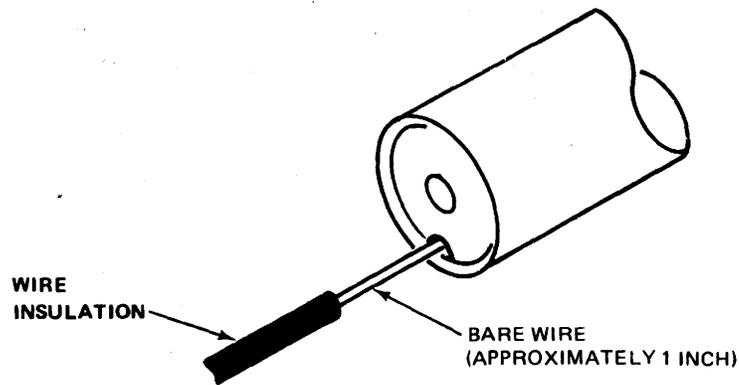
(A) INSERTION OF WIRE INTO LONGITUDINAL GROOVE
