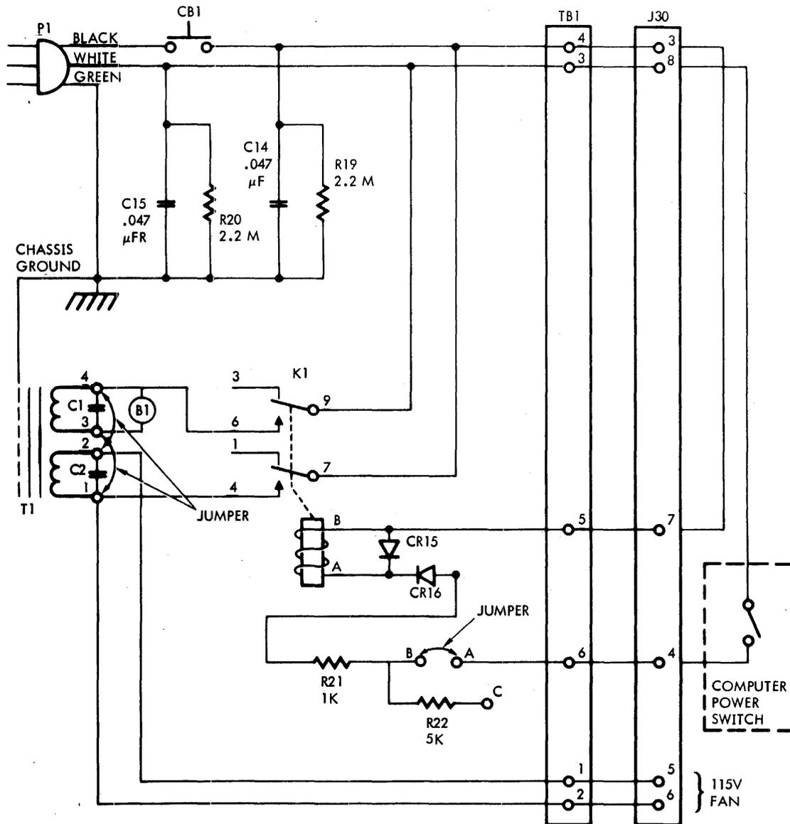
NOTE: JUMPERS ARE CONNECTED FOR 115 VOLT OPERATION
