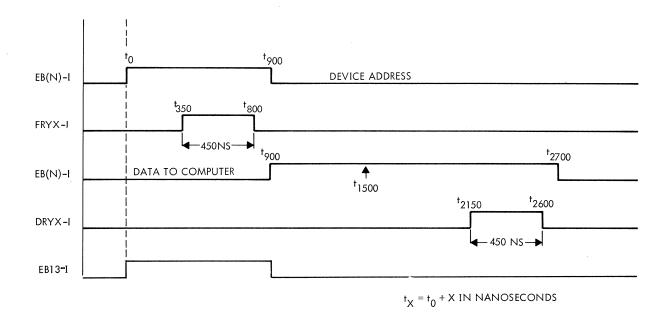
EB(N)-I - DATA - NORMALLY ON  $\rm t_{900}$  , MUST BE ON  $\rm t_{1500}$  NORMALLY OFF  $\rm t_{2700}$  , MUST BE OFF  $\rm t_{3300}$
