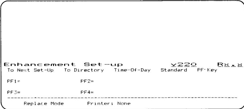
**Figure 3-10. Enhancement Set-Up Menu
