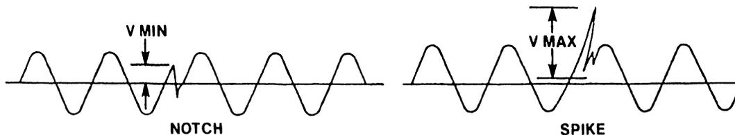
FIGURE 4-9 IMPULSE WAVEFORMS
