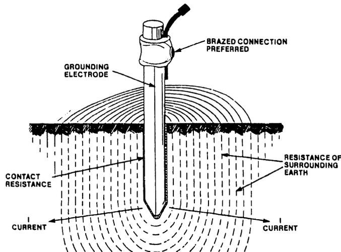
FIGURE 4-5 EARTH GROUND STAKE (Ground Rod)
