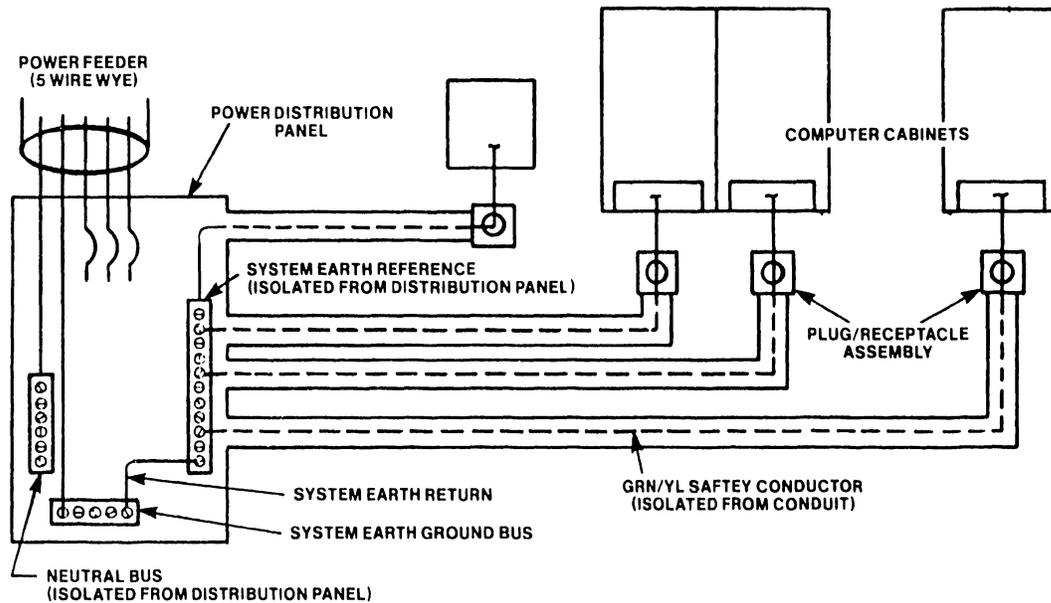
FIGURE 4-3 REPRESENTATIVE GROUND REFERENCE DISTRIBUTION
