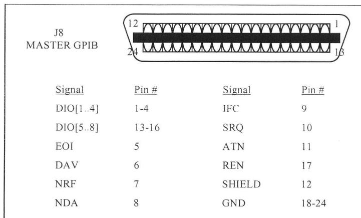
FIGURE 3 - GPIB Connector Diagram
