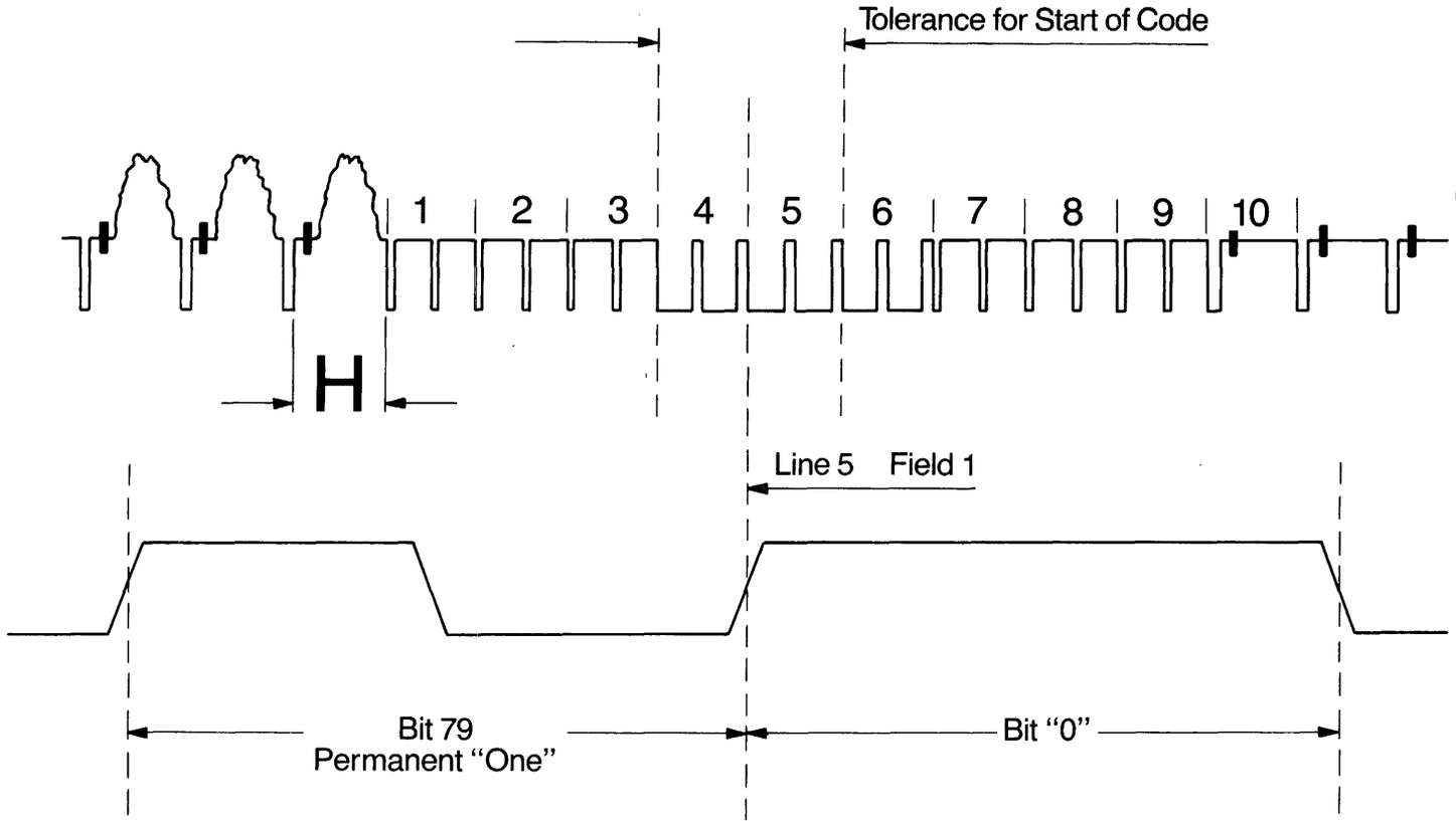
**Figure 5** — SYNCHRONIZATION OF TIME CODE AND VIDEO SIGNAL
