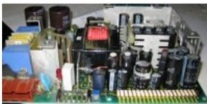
Vue sur les connecteurs de sortie et les plots de tests. J'ai ajouté une diode LED rouge sur la sortie 12V pour voir le fonctionnement. Les tensions de sortie sont nombreuses : +5,15V digital ; +3,5V analog ; -5,2V analog ; +12V analog ; -12V analog ; +12V display ; +15,5V ventilateur. Toutes les masses (0 volt) sont communes. On trouve aussi pas mal de potentiomètres un peu partout.
