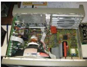
Vue du dessus : la platine principale est visible. Sur la gauche, toute la partie microprocesseur et sa périphérie (mémoires, entrées / sorties, ...). Sur la droite les atténuateurs d'entrées et les convertisseurs A/D. Cet appareil comporte 4 canaux de 500MHz.
