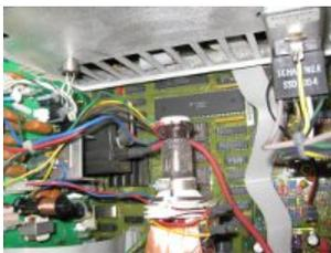
Une vue sur le microprocesseur : c'est un 68000. Choix logique pour l'époque où cet appareil a été conçu, la fin des années 80. Les données utilisateur sont stockées dans une mémoire RAM non volatile de Dallas Semiconductor : ces horreurs de circuits comprenant une pile moulée dans le boîtier! 20 ans après, elles sont devenues mauvaises évidemment!
