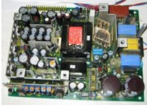
L'alimentation extraite de son coffret interne. Je pensais le dépannage simple, mais... Cette carte (construite par Boschert) est particulièrement complexe! Il s'agit bien d'une alim à découpage mais comportant aussi des régulations classiques... De plus la technique de commande du transistor de puissance n'apparaît pas au premier coup d'oeil : on ne trouve pas ici les circuits classiques de commande. Aïe !
