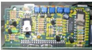
La platine de contrôle des tensions. Un LM339 (circuit intégré 14 pattes) sert de comparateur de tensions, un LM317 (boîtier TO220 de droite) donne la tension de référence pour les comparateurs. Un circuit «crowbar» à thyristor (boîtier TO220 de gauche) court-circuite une des sorties en cas de dépassement de tension, ceci pour ne pas «tuer» les utilisations en cas de défaillance de l'alimentation.
