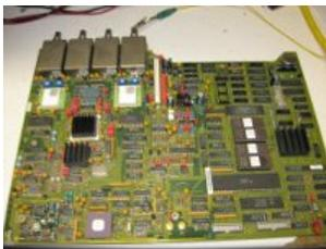
Maintenant, la totale. L'appareil peut refonctionner, donc il est temps de lui faire une bonne maintenance. Et pour commencer, remplacer la mémoire NVRAM (à pile intégrée). En effet, elle ne mémorise plus rien, et la calibration est perdue après chaque coupure. Pour cela, il faut extraire la grande carte-mère... Sur cette photo, la NVRAM est déjà dé-soudée et remplacée par un support 28 broches. (désolé pour la photo floue...)
