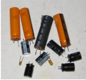
Premiers pas dans le dépannage (novembre 2010) : test statique de tous les semiconducteurs de puissance, désactivation du circuit «crowbar» (pour voir si ce n'est pas lui qui provoque le pompage),... Quelques condensateurs secondaires et de découplage remplacés, ...
