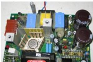
Vue côté primaire. On distingue très bien le filtre secteur (principalement les deux condensateurs bleus et la double self en forme de petit transfo), le redresseur et les deux condensateurs de filtrage (560 $\mu$ F). Le transistor de puissance est un TIPL755, monté sur dissipateur. Les autres composants sont montés à proximité. On trouve un TIP41, un 2N2222 et un unijonction 2N2647. Pas évident de comprendre le fonctionnement de prime abord...
