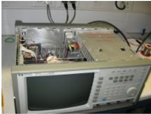
Une fois le capot supérieur enlevé, on découvre une électronique complexe. Le bloc d'alimentation se trouve dans le flux d'air du ventilateur, ce qui est bien sa place. Contre la paroi de gauche se trouve la commande et l'alimentation du tube CRT, et au fond du boîtier la platine de gestion occupe tout l'espace.
