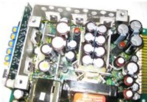
Vue côté secondaire. Pas mal de condensateurs, de grosses diodes refroidies et de selfs de filtrage : cette alimentation donne plusieurs tensions pour les différentes parties de l'appareil. Mais on voit aussi, curieusement, des régulateurs classiques LM350 et des transistors MOS sur dissipateur. Seul le relevé du schéma aidera à comprendre...
