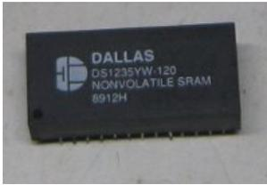
Le circuit NVRAM Dallas Semiconductor type DS1235YW, très utilisé par HP dans cette série d'oscilloscopes. Le code date est 8912 (12e semaine de 1989) : la pile interne aura quand même bien tenu le coup! Ce circuit n'est plus disponible et est remplacé par la référence DS1230Y.
