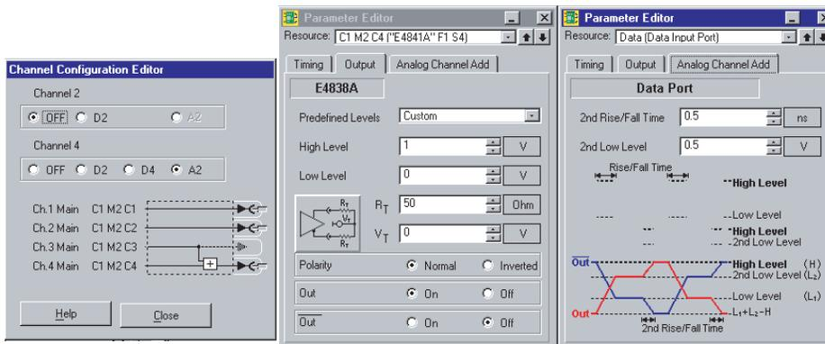
Fig 9a: Analog channel Add setup the E4838A
