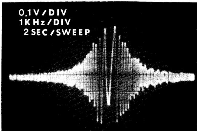
FIGURE 5-1 THIRD LOCAL OSCILLATOR ADJUSTMENT
