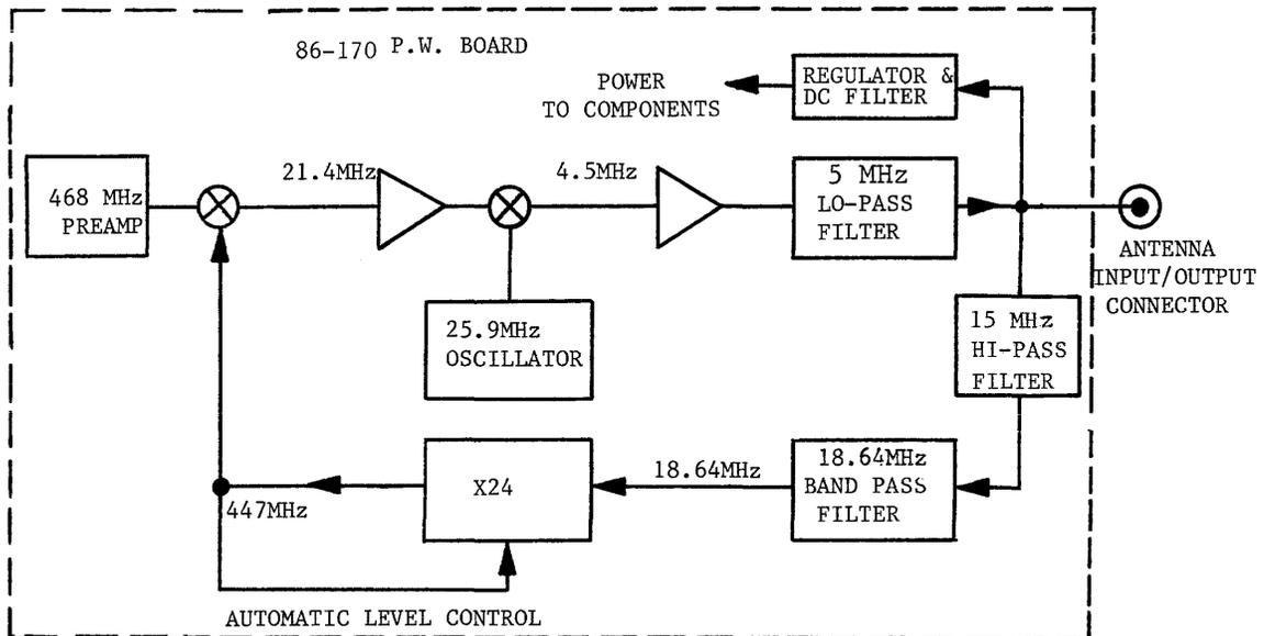
**FIGURE 4-3 ACTIVE ANTENNA BLOCK DIAGRAM - MODEL A-468MS**
