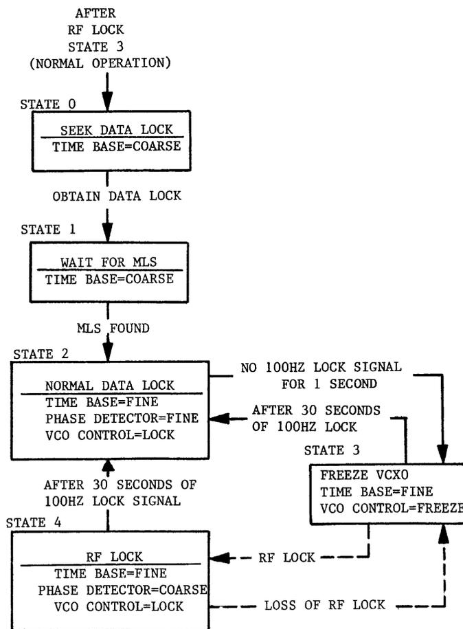
FIGURE 4-18 100Hz DATA LOCK STATE DIAGRAM
