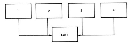
will appear on the listing as: PR1: . . . . . . . . . . . . . . . . . . . . BR EXIT PR2: . . . . . . . . . . . . . . . . BR EXIT PR3: . . . . . . . . . . . . . . . . . . . . . . . . BR EXIT PR4: . . . . . . . . . . . . . . . . . . . . . . . . EXIT: And not as: PR1: . . . . . . . . . . . . . . . . . . . . . . . . EXIT: . . . . . . . . . . . . . . . . . . . . . . . . PR2: . . . . . . . . . . . . . . . . . . . . EXIT BR PR3: . . . . . . . . . . . .
