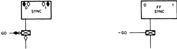
Figure 3-8 Trailing Edge Triggering
