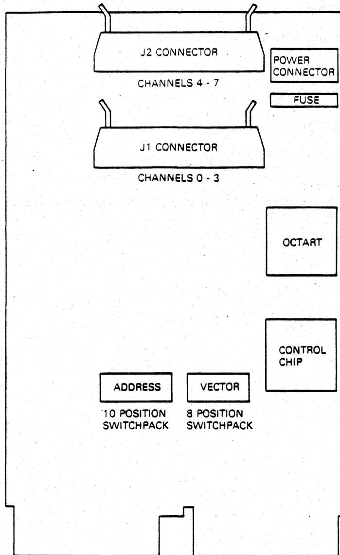
Figure 1-1 Layout of the DHQ11 Module
