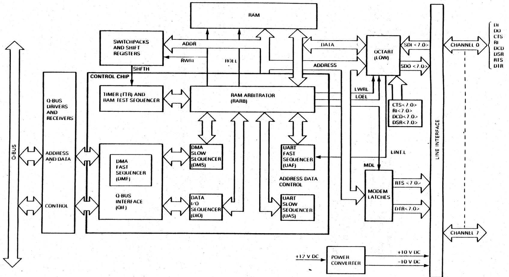
Figure 5-1 DHQ11 Block Diagram
