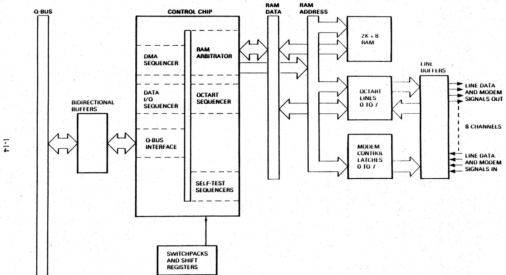
Figure 1-5 DHQ11 Functional Block Diagram
