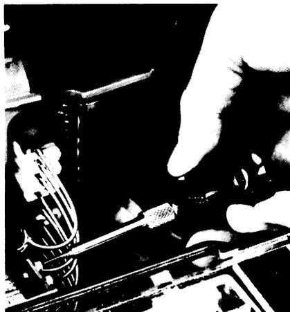
FIGURE 4-9. USING HEAD TORQUE TOOL
