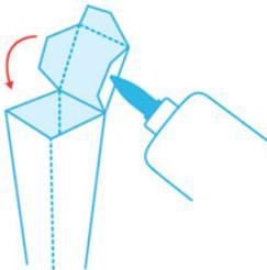
9. Tomar la parte superior de la pata y colocar una gota de pegamento en cada lengüeta. Doblarla hacia adentro y sujetarla con firmeza hasta que se seque completamente. Repetir el proceso con la otra pata.
