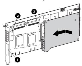
2. Insérez l'adaptateur dans le connecteur **3** de la carte contrôleur Smart Array 5300.
