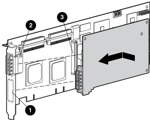
2. Stecken Sie die Adapterkarte in den Anschluß ❸ an der Array Controller-Karte.
