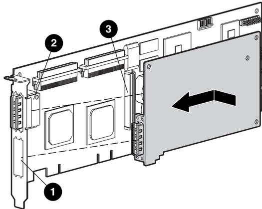
2. Conecte la placa del adaptador en el conector **3** de la placa del controlador de array.
