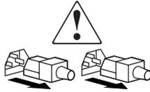
Diese Symbole auf Netzteilen oder Stromversorgungssystemen weisen darauf hin, dass das Gerät über mehrere Spannungsquellen mit Strom versorgt wird.
