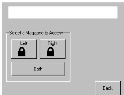
**Figura 41:** Pantalla Magazine access [Acceso al cargador] (se muestra el modelo de dos unidades)
