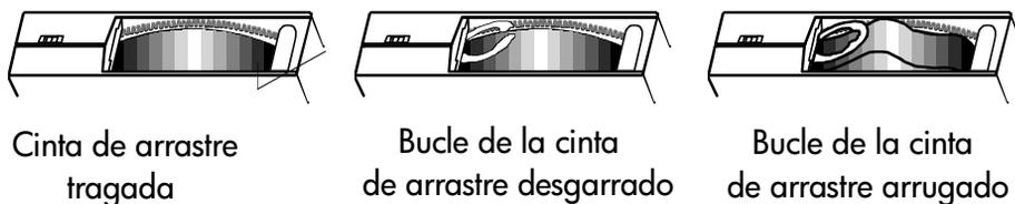
**Figura 75: Cintas de arrastre DLT defectuosas**
