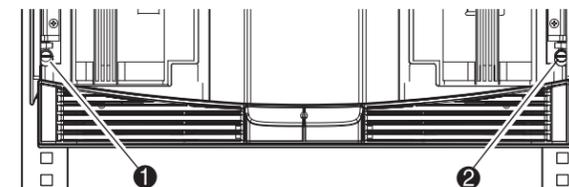
Befestigen Sie die Frontabdeckung bei geöffneten Türen mit den beiden Befestigungsschrauben am Rack.
