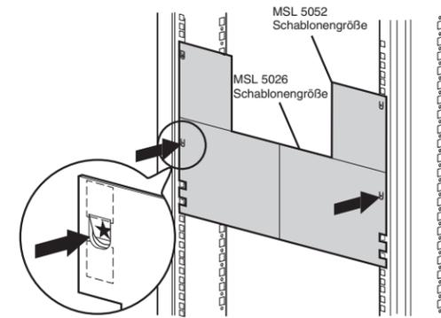
Verwenden Sie die mitgelieferte Schablone, um die Position der Befestigungsbeschläge an den Montageschienen des Racks zu markieren.
