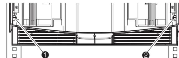
Tenendo gli sportelli aperti, fissare il pannello anteriore al cabinet utilizzando le due viti fornite.
