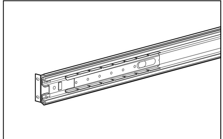
3. Ziehen Sie die Schiene heraus, bis eine Öffnung freiliegt und Sie die Schrauben einsetzen können.
