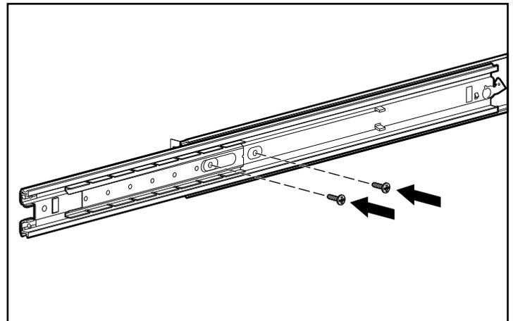
4. Schieben Sie die Schiene zurück, um Zugriff auf die restlichen Löcher zu erhalten. Setzen Sie die restlichen Schrauben ein, und ziehen Sie sie fest.
