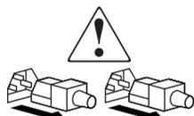
Diese Symbole auf Netzteilen oder Stromversorgungssystemen weisen darauf hin, dass das Gerät über mehrere Stromquellen versorgt wird.
