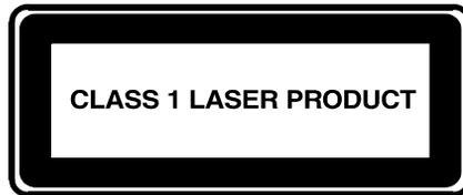
Dieses Etikett gibt an, dass das Gerät als Laserprodukt der Klasse 1 zertifiziert wurde. Dieses Etikett ist auf Lasergeräten angebracht, die in Ihrem Produkt installiert sind.
