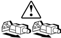
Diese Symbole an Netzteilen oder Stromversorgungssystemen weisen darauf hin, dass ein Gerät über mehrere Stromquellen versorgt wird.
