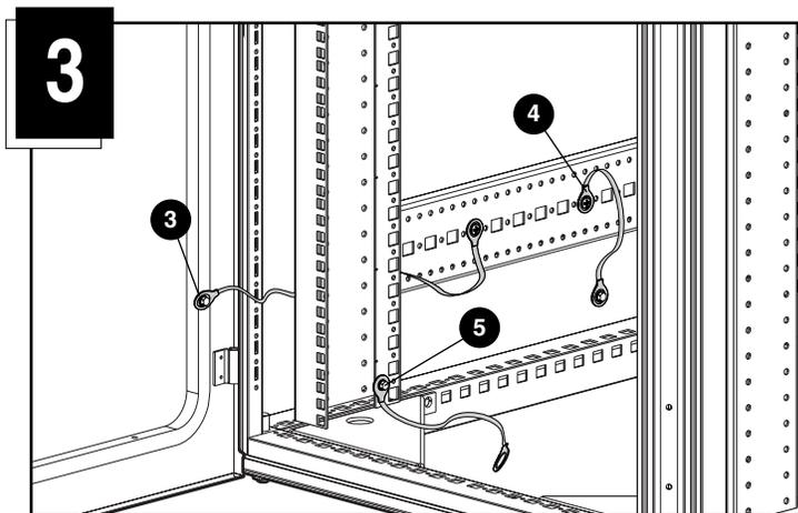
Dalla guida angolare di montaggio da 48,26 cm (19 pollici) alla parte superiore del rack, quindi al pannello perforato:
