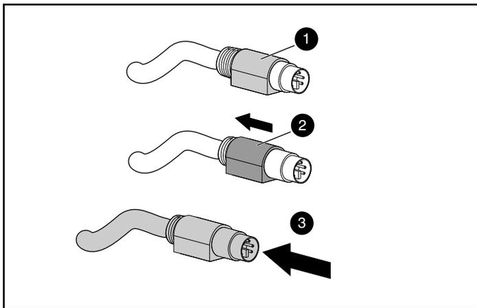
Per collegare il cavo, inserirlo nel connettore appropriato. Il meccanismo di arresto bloccherà il cavo in posizione corretta.
