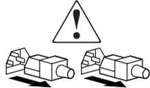
Diese Symbole auf Netzteilen oder Stromversorgungssystemen weisen darauf hin, dass mehrere Stromquellen vorhanden sind.
