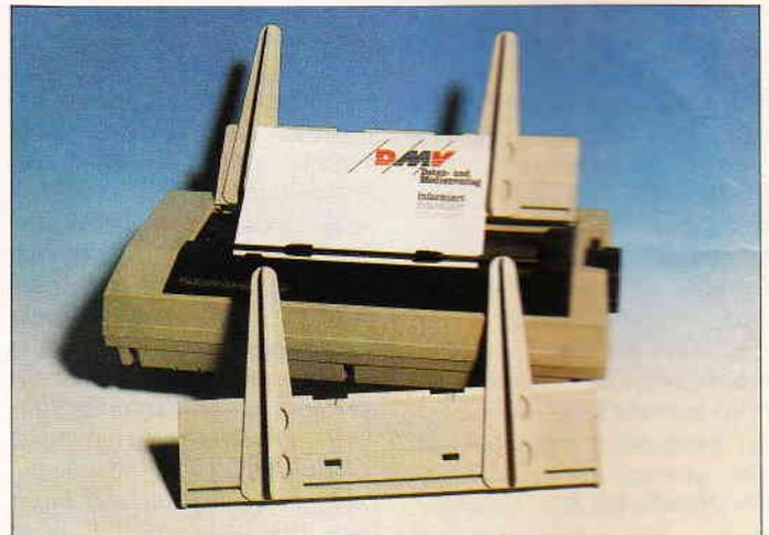
Der DMV-Verlag bietet neu als Zubehör für den Joyce eine Einzelblattführung an, die an den Drucker angesteckt wird. Diese Einzelblattführung, die aus grauem ABS-Plastik hergestellt wird, hält das Papier während des Druckens völlig gerade, verarbeitet Papiergrößen von 45 mm bis 260 mm und läßt das zweimalige Bedrucken eines Blattes mit korrekter Blattführung zu. Auf der Führung sind alle vier
