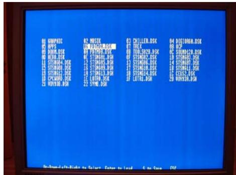
*Komfortabler Disketten-Wechsel ohne Mechanik. Alle DSK werden auf der CF-Card abgelegt.*
