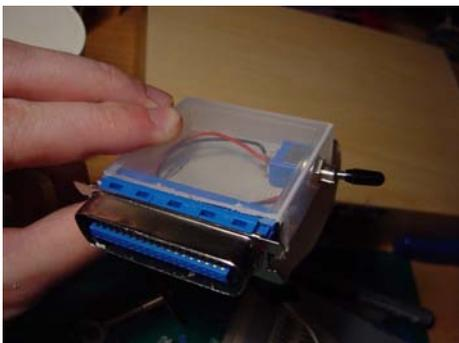
Hier etwas zurechtgestutzt mit eingeschraubten Schalter. Das ganze wird nun noch verklebt und angesprüht.
