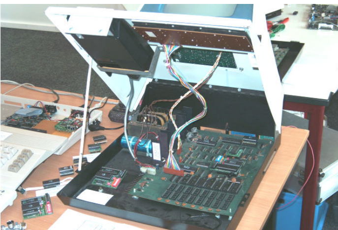
PET2001 mit eingebauter Datasette im offenen Zustand. Schon gut, so ne Haltestange!
