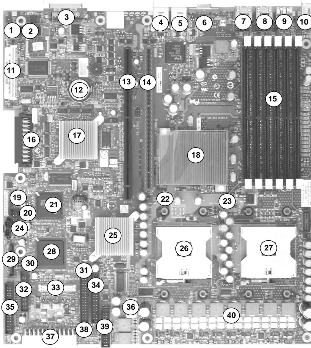
Figure 43. Intel® Server Board SE7520JR2 Layout
