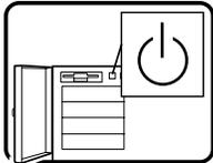
L'interruttore attivato/disattivato nel pannello anteriore non interrompe l'alimentazione in c.a. del sistema. Per interromperla, è necessario scollegare tutti i cavi di alimentazione in c.a. dalle prese a muro o dall'alimentazione di corrente.
