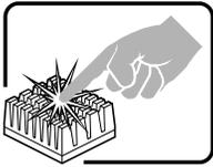
Der Mikroprozessor und der Kühler sind möglicherweise erhitzt, wenn das System in Betrieb ist. Außerdem können einige Platinen und Gehäuseteile scharfe Spitzen und Kanten aufweisen. Arbeiten an Platinen und Gehäuse sollten vorsichtig ausgeführt werden. Sie sollten Schutzhandschuhe tragen.
