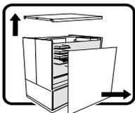
Dopo aver seguito i sei passi di SICUREZZA sopracitati, togliere le coperture del telaio del sistema come segue:
