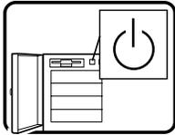
Nótese que el interruptor activado/desactivado en el panel frontal no desconecta la corriente alterna del sistema. Para desconectarla, deberá desenchufar todos los cables de corriente alterna de la pared o desconectar la fuente de alimentación.
