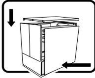
Para obtener un enfriamiento y un flujo de aire adecuados, reinstale siempre las tapas del chasis antes de poner en marcha el sistema. Si pone en funcionamiento el sistema sin las tapas bien colocadas puede dañar los componentes del sistema. Para instalar las tapas:
