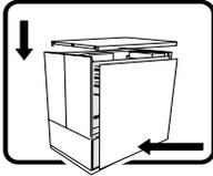
Afin de permettre le refroidissement et l'aération du système, réinstallez toujours les panneaux du boîtier avant de mettre le système sous tension. Le fonctionnement du système en l'absence des panneaux risque d'endommager ses pièces. Pour installer les panneaux, procédez comme suit :
