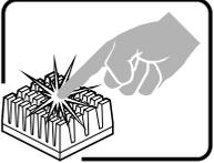
Si el sistema ha estado en funcionamiento, el microprocesador y el dissipador de calor pueden estar aún calientes. También conviene tener en cuenta que en el chasis o en el tablero puede haber piezas cortantes o punzantes. Por ello, se recomienda precaución y el uso de guantes protectores.
