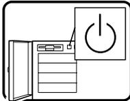
Der Wechselstrom des Systems wird durch den Ein-/Aus-Schalter für Gleichstrom nicht ausgeschaltet. Ziehen Sie jedes Wechselstrom-Netzkabel aus der Steckdose bzw. dem Netzgerät, um den Stromanschluß des Systems zu unterbrechen.
