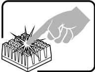
Le microprocesseur et le dissipateur de chaleur peuvent être chauds si le système a été sous tension. Faites également attention aux broches aiguës des cartes et aux bords tranchants du capot. Nous vous recommandons l'usage de gants de protection.
