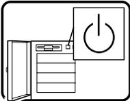
Notez que le commutateur CC de mise sous tension /hors tension du panneau avant n'éteint pas l'alimentation CA du système. Pour mettre le système hors tension, vous devez débrancher chaque câble d'alimentation de sa prise.
