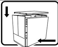
Zur ordnungsgemäßen Kühlung und Lüftung muß die Gehäuseabdeckung immer wieder vor dem Einschalten installiert werden. Ein Betrieb des Systems ohne angebrachte Abdeckung kann Ihrem System oder Teile darin beschädigen. Um die Abdeckung wieder anzubringen:
