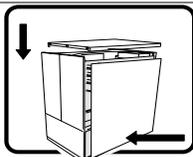
Per il giusto flusso dell'aria e raffreddamento del sistema, rimettere sempre le coperture del telaio prima di riaccendere il sistema. Operare il sistema senza le coperture al loro proprio posto potrebbe danneggiare i componenti del sistema. Per rimettere le coperture del telaio:
