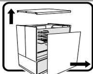
Dopo aver seguito i sei passi di SICUREZZA sopracitati, togliere le coperture del telaio del sistema come segue:
