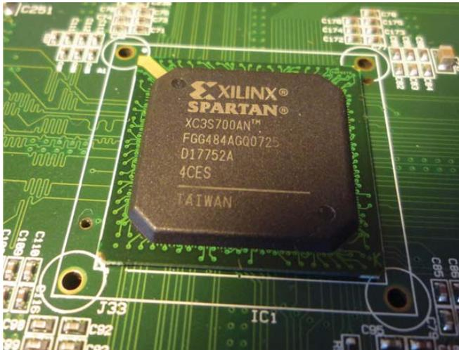
Figure 3. Spartan XC3S700AN FPGA
