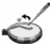
4. Insérez une nouvelle pile au lithium 3V (CR2032) dans le logement et appuyez jusqu'à ce que les clips s'enclenchent et retiennent la pile. Vous devrez ensuite réinitialiser la date et l'heure système.
