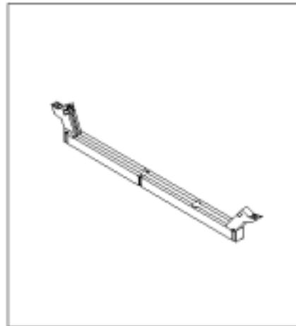
3. Vérifiez que les encoches de la barrette DIMM sont bien alignées sur le connecteur. Enfoncez la barrette DIMM dans le connecteur jusqu'à ce que les crochets de retenue se referment.
