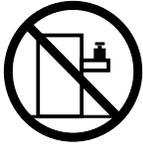
Não coloque nenhum objeto com peso superior a 50 kg (110 lbs.) sobre dispositivos montados em rack.
