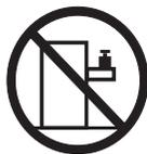
Non poggiare oggetti che pesano più di 82 kg sulla parte superiore delle unità montate in rack.
