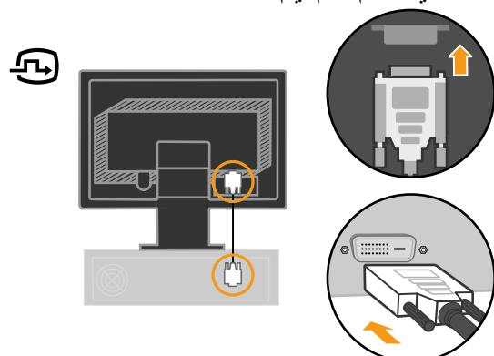
٤ - أدخل كبل الطاقة في الجزء المخصص له على الشاشة، ثم قم بتوصيل هذا الكبل وكبل جهاز الكمبيوتر
