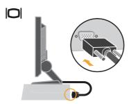
3. Connecter le câble numérique au connecteur DVI du moniteur e t l'autre extrémité sur l'arrière de l'ordinateur.
