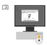
7. Pour optimiser la qualité d'image du moniteur, appuyez sur la touche de réglage automatique de l'image. Pour que le réglage automatique se fasse, le moniteur doit être sous tension depuis au moins 15 minutes. Cette précaution n'est pas nécessaire pour un fonctionnement normal.
